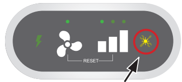
Led fijo: señalización de sustitución
